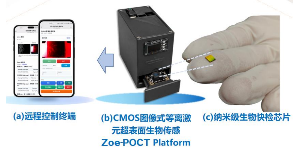
图 1 图像式等离子激元超表面生物传感系统实物及组成
